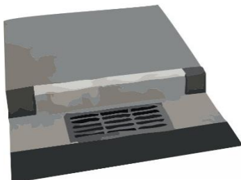
Figura 127 – Boca de lobo com grelha
