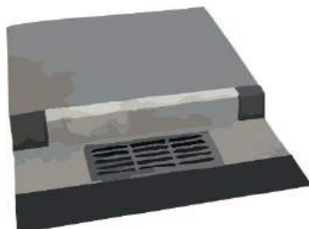
Figura 127 – Boca de lobo com grelha
